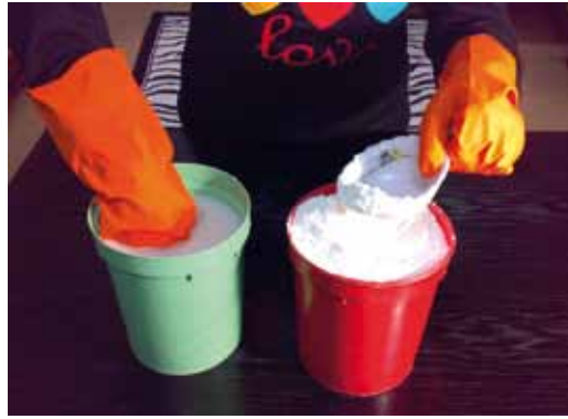
الشَّكْلُ (١٣-٣): طريقةُ خلطِ الجبسِ بالماءِ بنثرِ بودرةِ الجبسِ على الماءِ وتحريكها باليدِ بشكلٍ مستمرٍّ.
